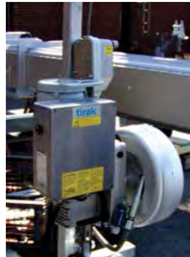
Cabrestante tirak® con carrete pasivo en una plataforma
